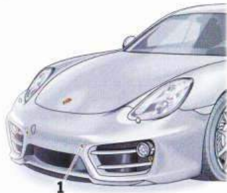
Capteurs à ultrasons avant
