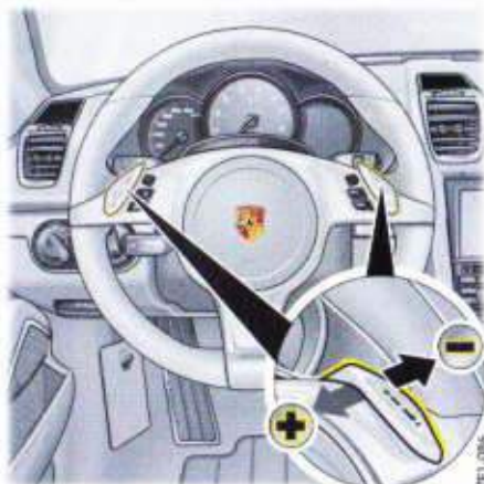
Volant avec touches de passage de rapport
