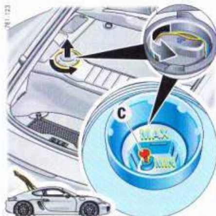
C - Témoin d'affichage du liquide de refroidissement
