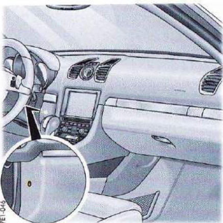
Capteur de température de l'habitacle
