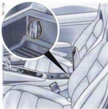
Prise de console centrale
