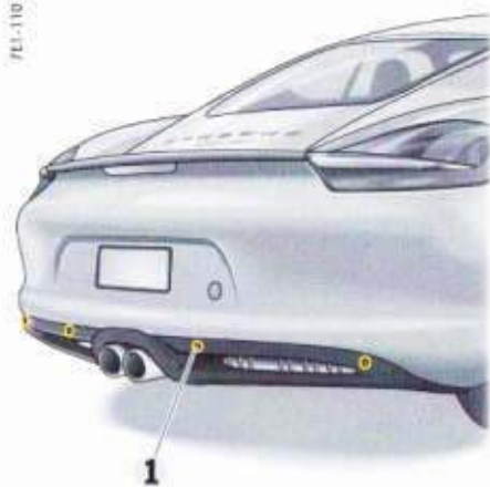
Capteurs à ultrasons arrière
