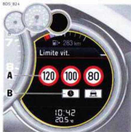
A - Panneaux de signalisation principaux B - Panneaux supplémentaires
