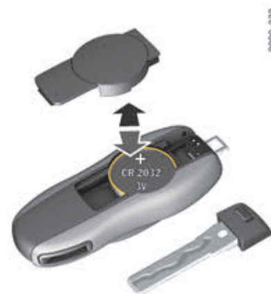
Fig. 61 : Remplacement de la pile
