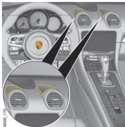
Fig. 70 : Zone de ventilation supérieure
