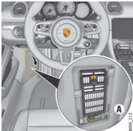
Fig. 182 : Prise de diagnostic dans la boîte à fusibles au niveau du plancher côté gauche
