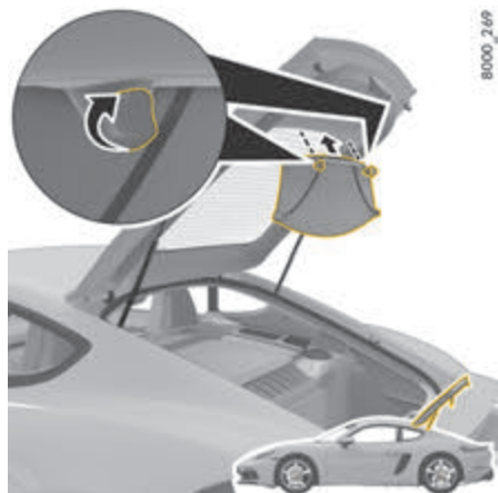
Fig. 91 : Mise en place du cache-bagages
