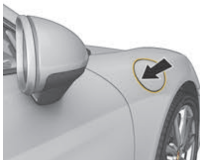
Fig. 188 : Ouverture de la trappe du réservoir
