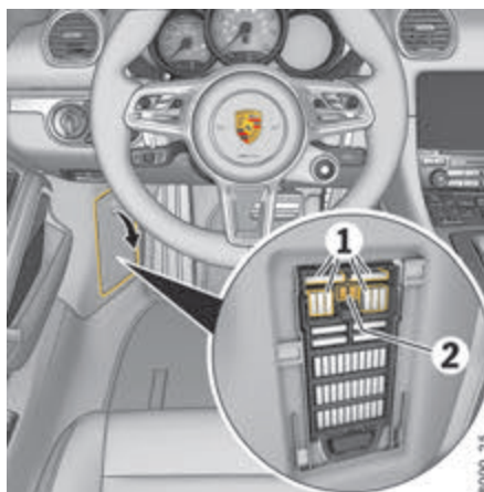
Fig. 135 : Éléments dans la boîte à fusibles au niveau du plancher côté gauche
