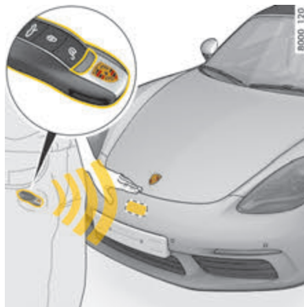
Fig. 36 : Ouverture du capot du coffre à bagages avant avec Porsche Entry & Drive
