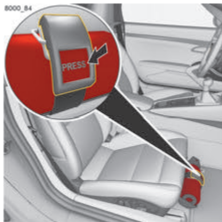
Fig. 115 : Extincteur sous le siège passager
