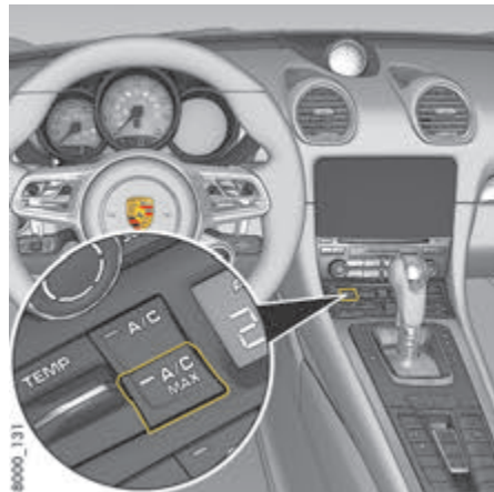
Fig. 72 : Activation du refroidissement maximal
