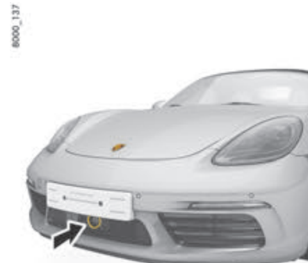
Fig. 196 : Position du capteur radar
