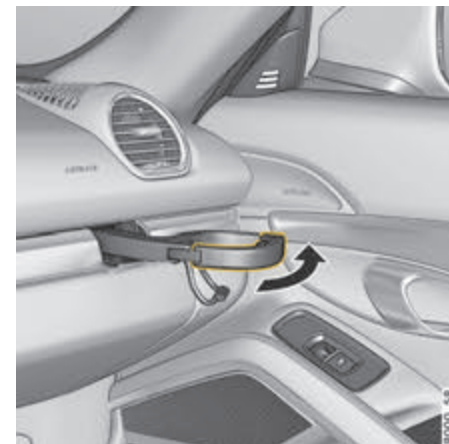
Fig. 181 : Déploiement d'un porte-boissons
