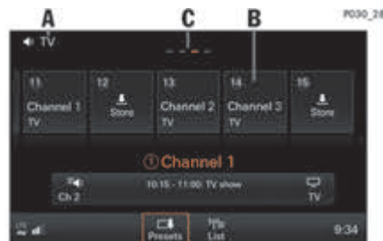
Fig. 238 : Touches de station (Presets) avec chaînes TV
