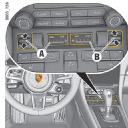
Fig. 76 : Réglage de la température et du débit d'air
