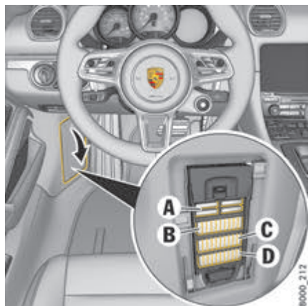
Fig. 136 : Porte-fusibles au niveau du plancher côté conducteur
