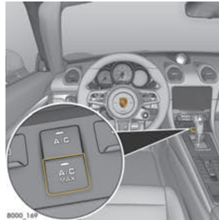
Fig. 80 : Activation du refroidissement maximal
